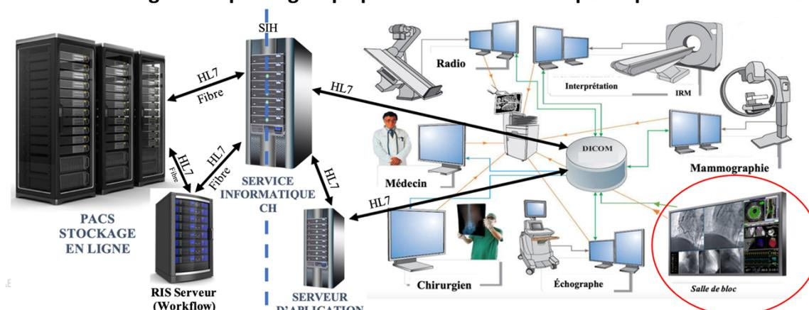
Figure 17 Schéma système de communication DICOM/PACS
