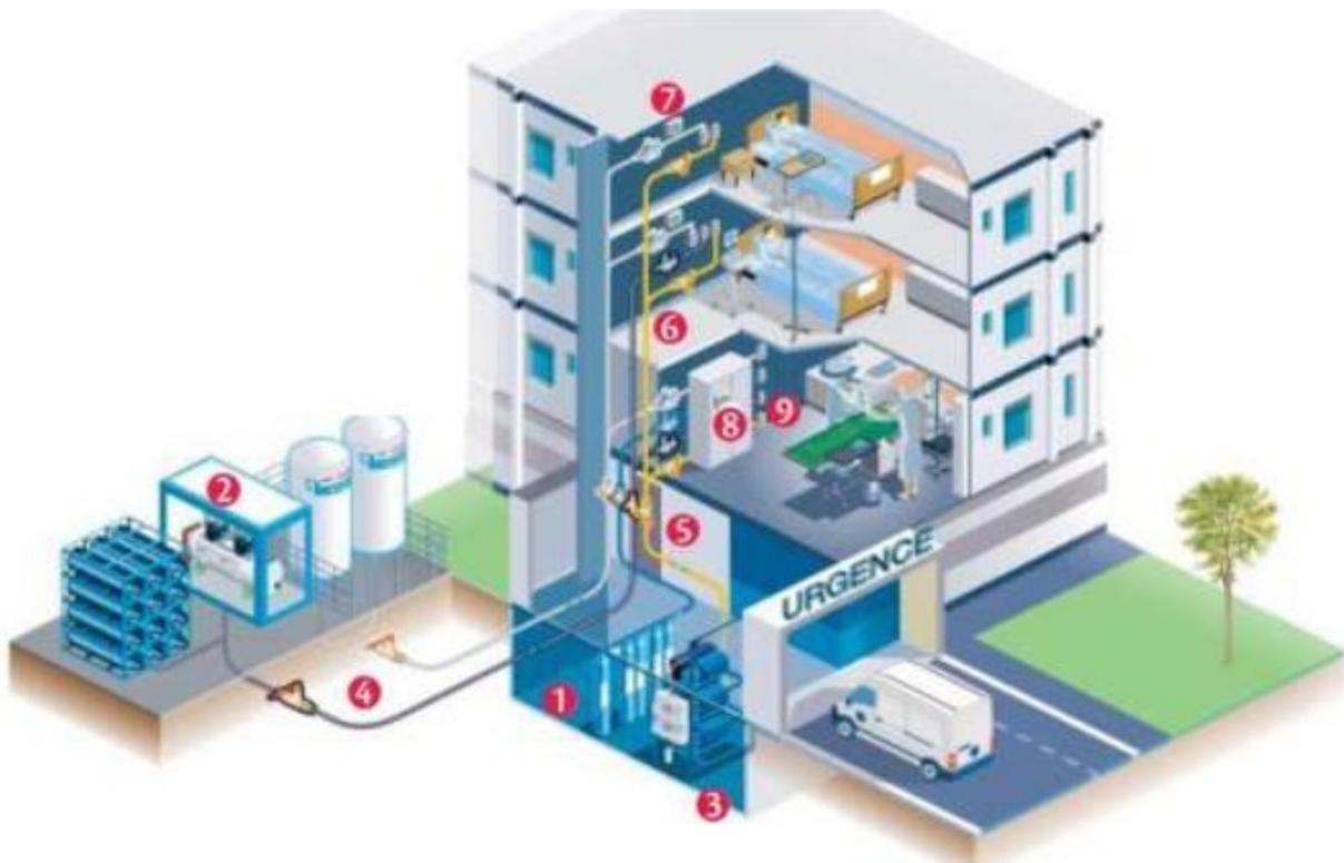
Figure 18 Système de distribution de gaz
