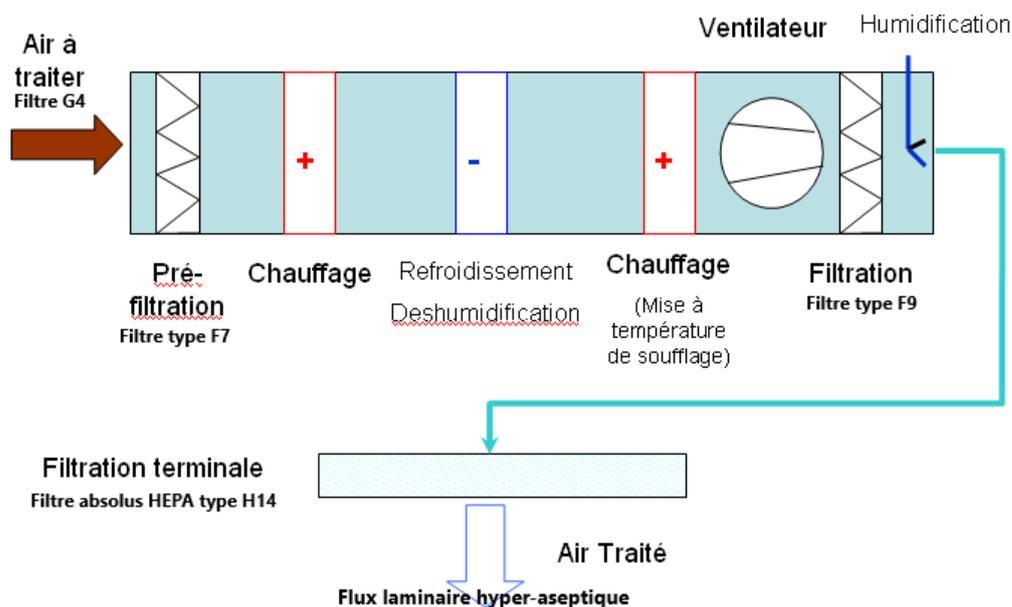
Figure 25 Centrale de traitement d'air
