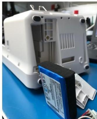
Déconnecter la batterie, la contrôler visuellement et vérifier sa date de mise en service <2 ans
