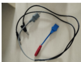
Deux câbles plaques modifiés, un pour le test REM l'autre pour les tests en monopolaire.
