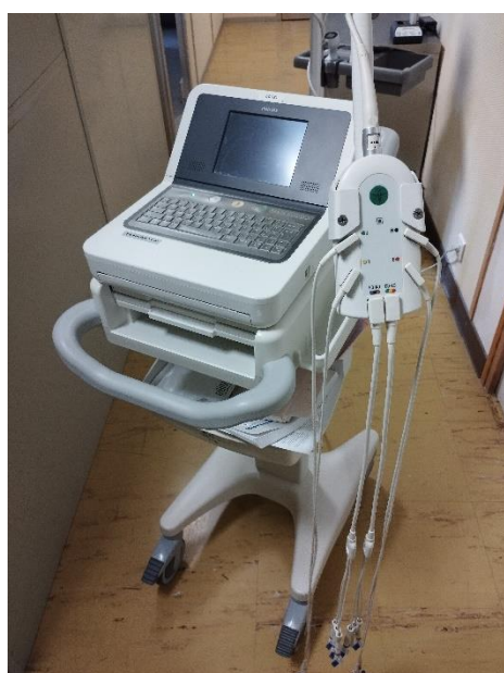
Figure 15 électrocardiographe TC30 PHILIPS, photo de l'auteur
