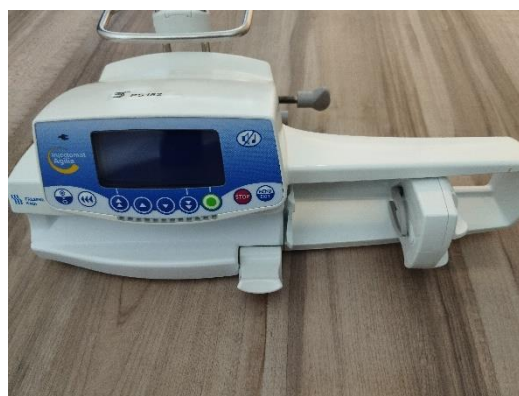
Figure 10 pousse seringue Injectomat Agilia FRESENIUS, photo de l'auteur
