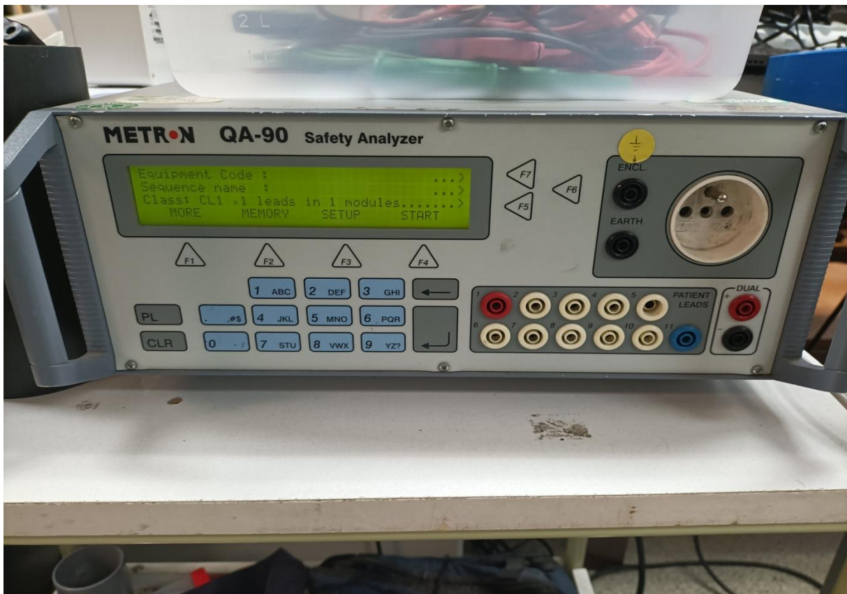
Photo : Testeur sécurité électrique du CHMY
